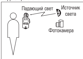
Рис. 1. Метод измерения падающего света
